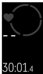
心拍数のシグナルを検出できない場合は、まず、デバイスの設定アプリで心拍数の追跡がオンになっていることを確認してください。次に、トラッカーを正しく装着しているか確認し、手首を上下に動かすか、リストバンドをきつくしたり、緩めたりしてみてください。Inspire HR が皮膚に接触している状態にします。腕をまっすぐ伸ばした状態で短時間動かさないようにすると、再び心拍数が表示されるはずです。
